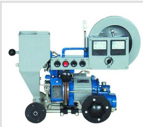
Автомат тракторного типа, предназначен для электродуговой сварки или наплавки под слоем флюса низкоуглеродистых и легированных сталей плавящимся электродом на постоянном токе с независимыми от параметров дуги скоростями сарки и подачи электродной проволоки, плавным изменением сварочного напряжения. Обеспечивает сварку соединений встык с разделкой и без разделки кромок, угловых и нахлесточных швов.
