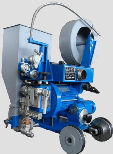
Автомат сварочный тракторного типа КА008 предназначен для электродуговой сварки на постоянном токе плавящимся электродом под слоем флюса стыковых швов вертикальным электродом с разделкой и без разделки кромок. Сварка при этом осуществляется вне колеи автомата.
