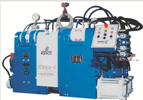
Машина предназначена для контактной стыковой сварки в полевых условиях пульсирующим оплавлением рельсов площадью поперечного сечения от 6500 мм<sup>2</sup> до 10000 мм<sup>2</sup> со снятием грата непосредственно после сварки в составе передвижных рельсосварочных установок.
