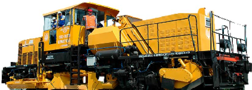
Планировщик балласта СПЗ-5 предназначен для планирования, перераспределения и окончательного формирования свеженасыпанного балласта при строительстве, всех видах ремонта и текущем содержании железнодорожного пути.
