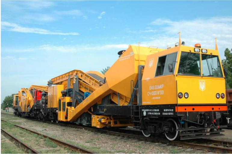
Машина путевая, самоходная, двухсекционная предназначена для очистки от засорителей щебеночного балласта на перегонах, станционных путях, в т.ч. у платформ, с подъемом и сдвигом колеи, с отбросом засорителей в сторону от колеи или в специальный подвижной состав, укладка очищенного балласта под рельсошпальную решетку, а также для вырезки (без очистки) балласта.
