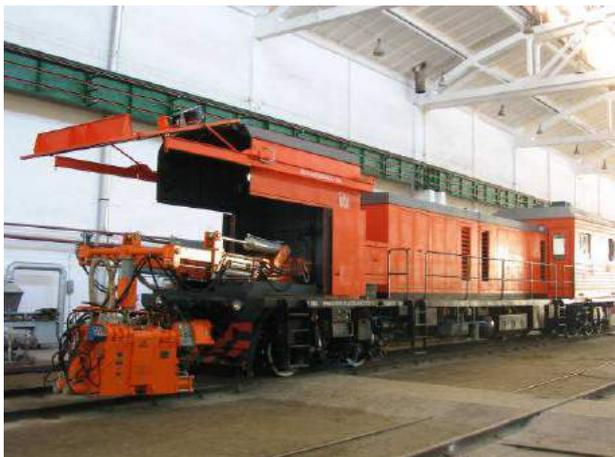
Машина КРС-1 предназначена для контактной стыковой сварки рельсов сечением от 6500 мм<sup>2</sup> до 10000 мм<sup>2</sup> непосредственно на пути во время строительства и ремонта железнодорожного пути.
